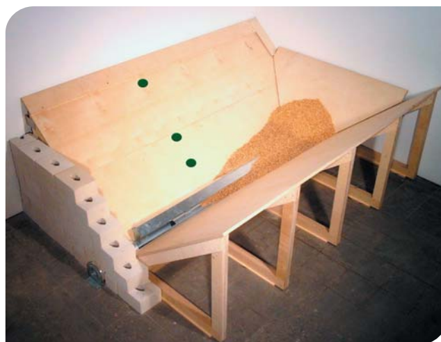
[Abb. 9] Drucksensoren zur Füllstandsmessung im Schrägbodenlager
